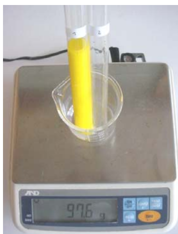
Medição da massa do conjunto de tubos de ensaio, após a reacção química entre o nitrato de chumbo (II) e o iodeto de potássio.
