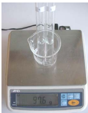
Medição da massa do conjunto de tubos de ensaio, antes da reacção química entre o nitrato de chumbo (II) e o iodeto de potássio.
