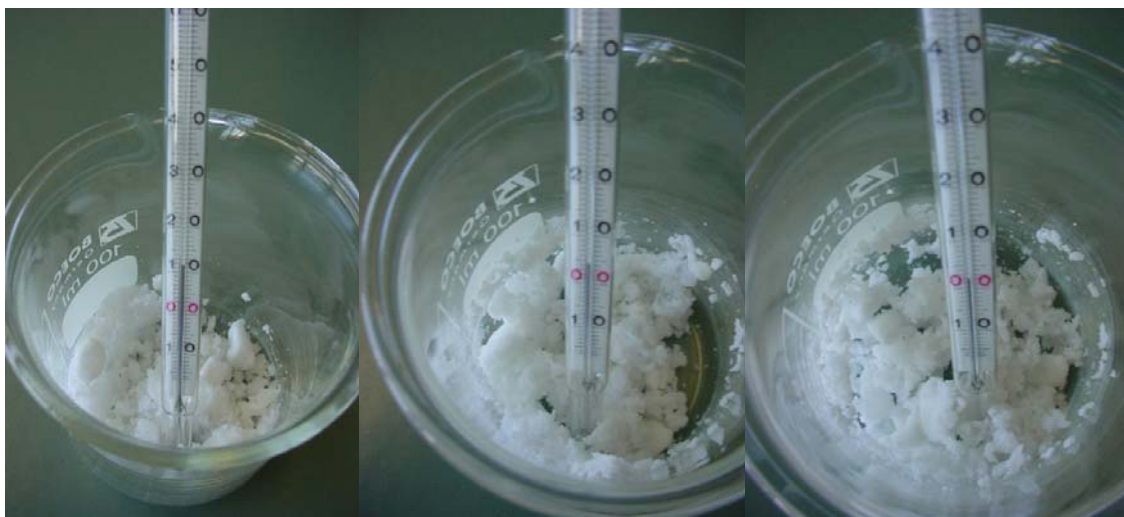
Varição da temperatura da mistura de hidróxido de bário com cloreto de amónio.
