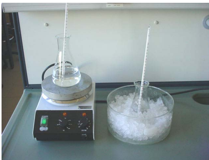
Montagens para o aquecimento e para o arrefecimento da água.
