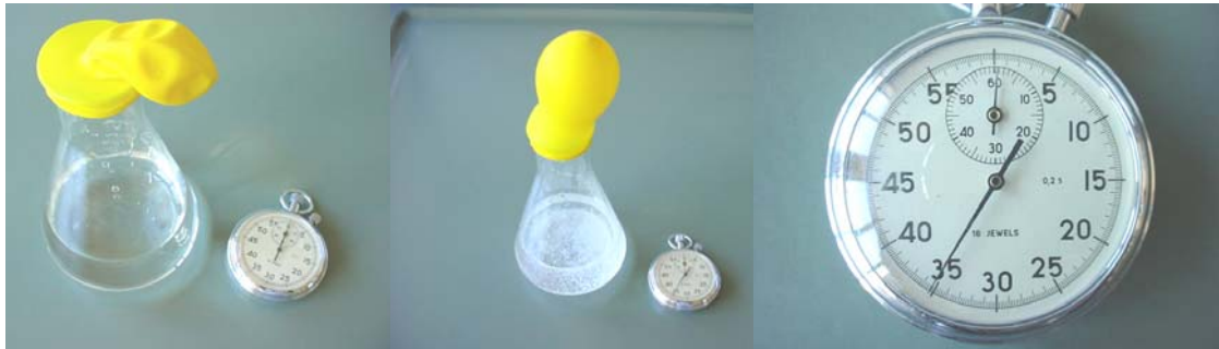
Decorrer da reacção química entre o Alka-Seltzer e a água no ensaio 1.
