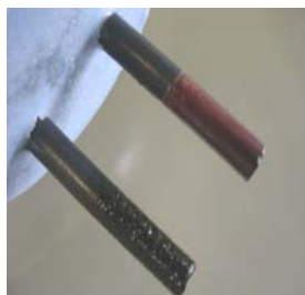
Depósito de cobre no eléctrodo de grafite.
