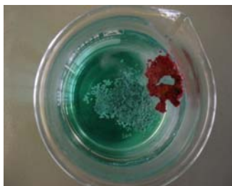
Cobre sobrenadante na solução.
