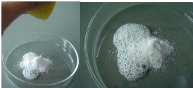
Reacção entre o ácido cítrico do limão com o hidrogenocarbonato de sódio.
