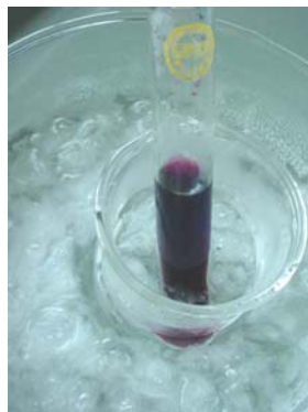
Montagem para o arrefecimento do tubo de ensaio com a solução saturada de cloreto de hexaquocobalto (II).
