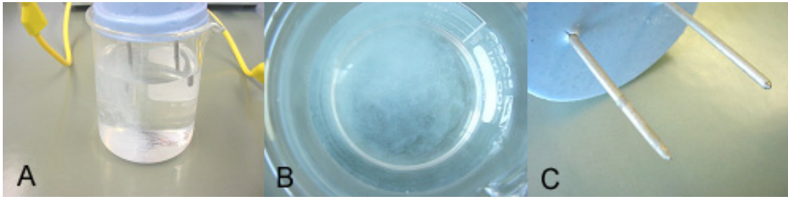
Aspecto da solução (A e B) e dos eléctrodos de zinco (C) após a electrólise da água.
