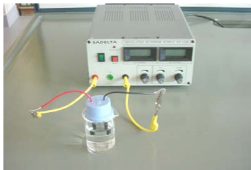
Montagem para proceder a electrólise da água com eléctrodos de grafite.
