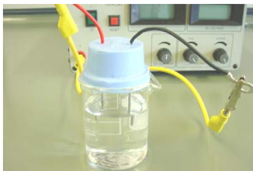
Montagem para proceder a electrólise da água com eléctrodos de zinco.
