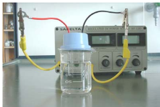
Montagem para proceder a electrólise da água com eléctrodos de ferro.
