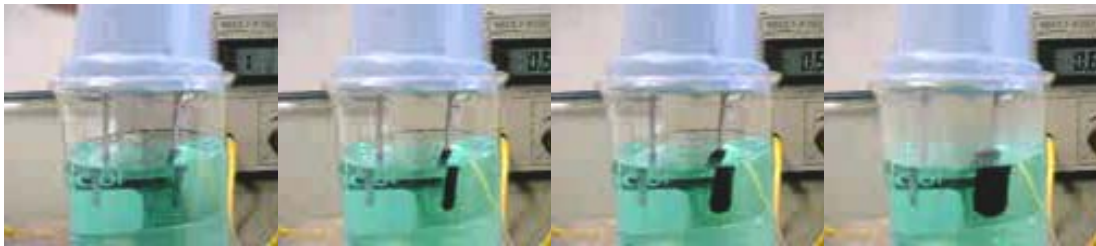
Electrólise da solução aquosa de cloreto de cobre (II) com eléctrodos de zinco.
