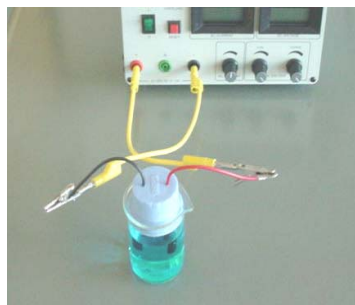
Montagem para proceder a electrólise da solução aquosa de cloreto de cobre (II) com eléctrodos de grafite.
