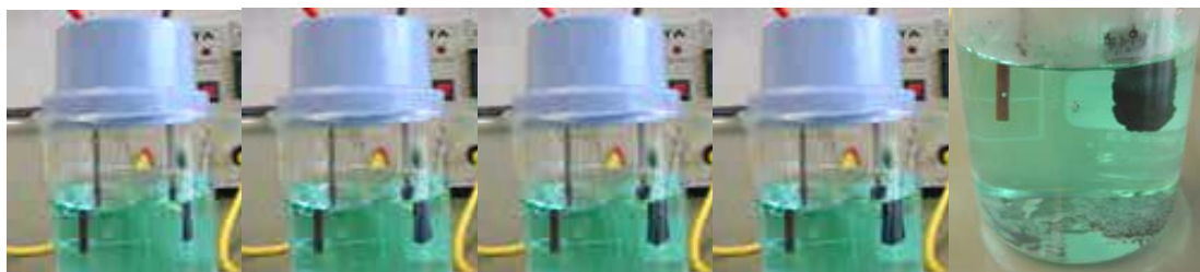
Electrólise da solução aquosa de cloreto de cobre (II) com eléctrodos de ferro.
