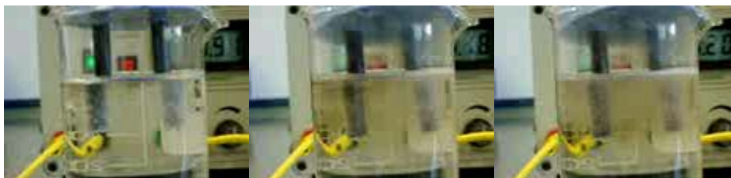
Electrólise da solução aquosa de hidróxido de sódio com eléctrodos de grafite.
