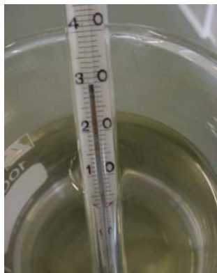
Medição da temperatura da solução aquosa de hidróxido de sódio após a electrólise com eléctrodos de ferro.
