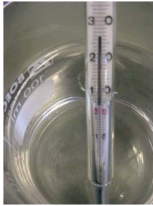
Medição da temperatura da solução aquosa de hidróxido de sódio após a electrólise com eléctrodos de zinco.
