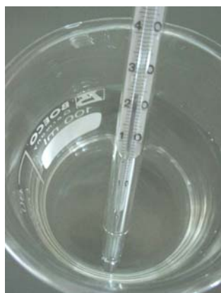
Medição da temperatura inicial da solução aquosa de hidróxido de sódio.
