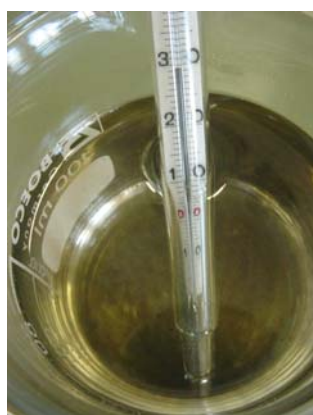
Medição da temperatura da solução aquosa de hidróxido de sódio após a electrólise com eléctrodos de grafite.
