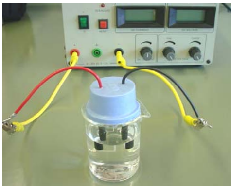
Montagem para proceder a electrólise da solução aquosa de hidróxido de sódio com eléctrodos de grafite.
