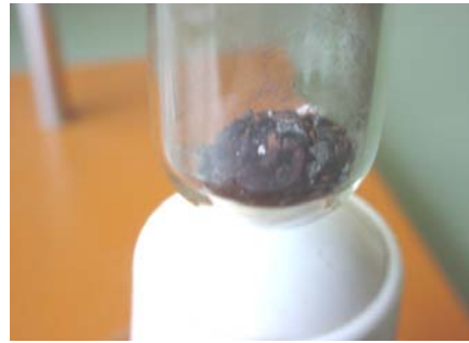
Pequenos pedaços de cor vermelha – cobre sólido.
