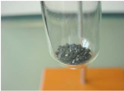
Aspecto da mistura de óxido de cobre com carvão.
