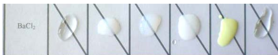
Formação dos precipitados brancos de carbonato, hidróxido e sulfato de bário e do precipitado de cor amarela pastel de cromato de bário.
