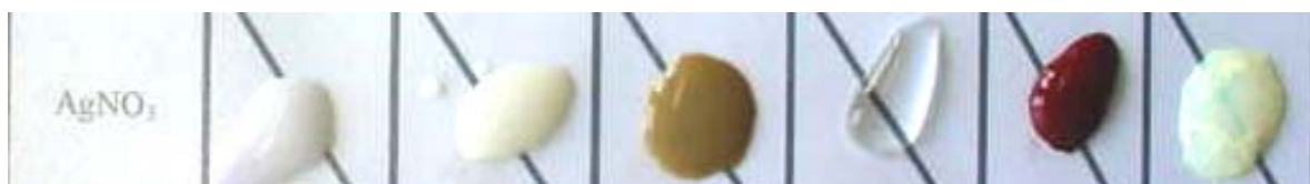
Formação dos precipitados brancos de cloreto de prata, carbonato de prata e iodeto de prata, do precipitado castanho de hidróxido de prata e do precipitado vermelho escuro cromato de prata.
