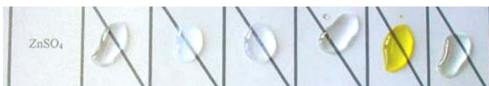
Formação dos precipitados brancos quase imperceptíveis de carbonato e hidróxido de zinco.
