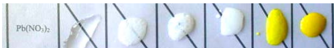
Formação dos precipitados brancos de carbonato, hidróxido e sulfato de chumbo (II), do precipitado amarelo claro de cromato de chumbo (II) e do precipitado amarelo iodeto de chumbo (II).
