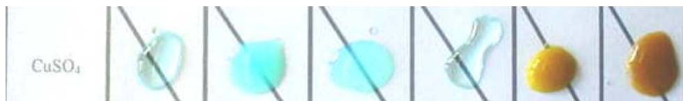
Formação dos precipitados de cor azul de carbonato e hidróxido de cobre (II) e dos precipitados amarelo avermelhado e laranja escuro de cromato e iodeto de cobre (II), respectivamente.
