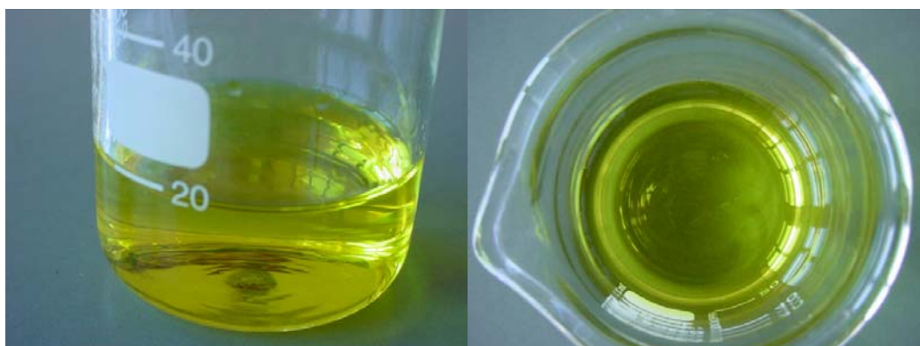
Aspecto da solução aquosa de cloreto de sódio e de cromato de potássio antes da adição de solução aquosa de nitrato de prata.
