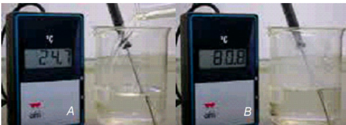
Temperatura da água antes da reacção com o ácido sulfúrico (A). Temperatura máxima atingida durante o decorrer da reacção química com o ácido sulfúrico (B).
