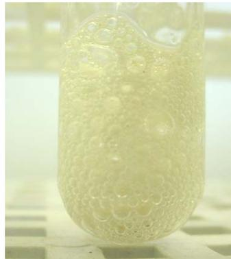
**Reacção química entre o ácido nítrico e o carbonato de cálcio existente no calcário.**
