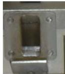
3. Ajustar a superfície polida do bloco-padrão no prisma, usando uma gota de bromonaftaleno;
