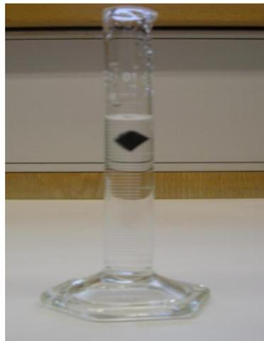
Fig. 5.3. Amostra nº 6 (de PS) em suspensão na solução da  $\text{CaCl}_2$
