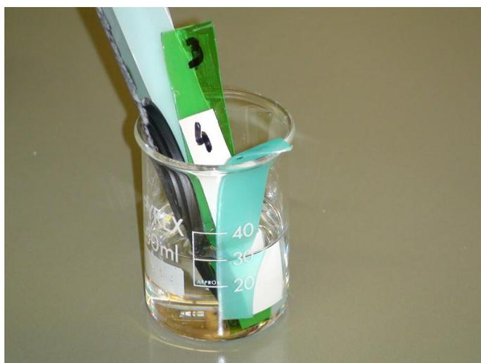
Fig.5.7. Colocação das amostras no gobelé.
