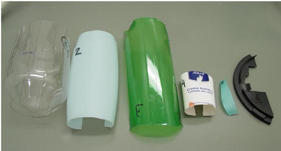
Fig.3.1. Objectos de PET, HDPE, PVC, LDPE, PP e PS (da esquerda para a direita) numerados de 1 a 6 pela ordem apresentada.
