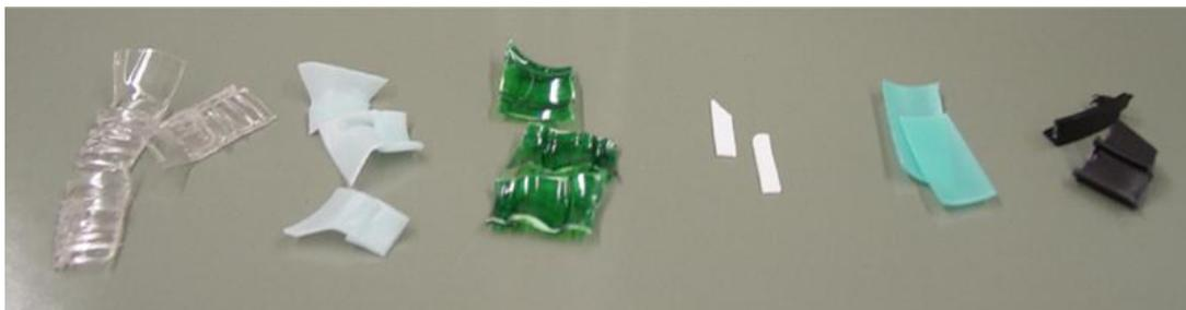
Fig.5.1. Amostras para a realização do teste da densidade
