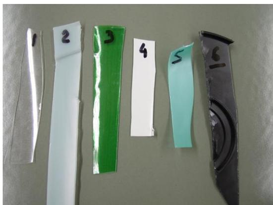
Fig.5.6. Amostras para a realização do teste do comportamento com solvente
