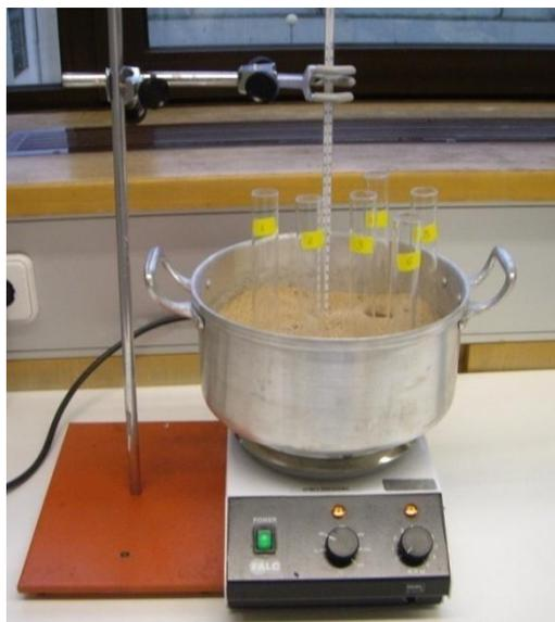
Fig.5.5. Montagem do termómetro e dos tubos de ensaio no banho de areia
