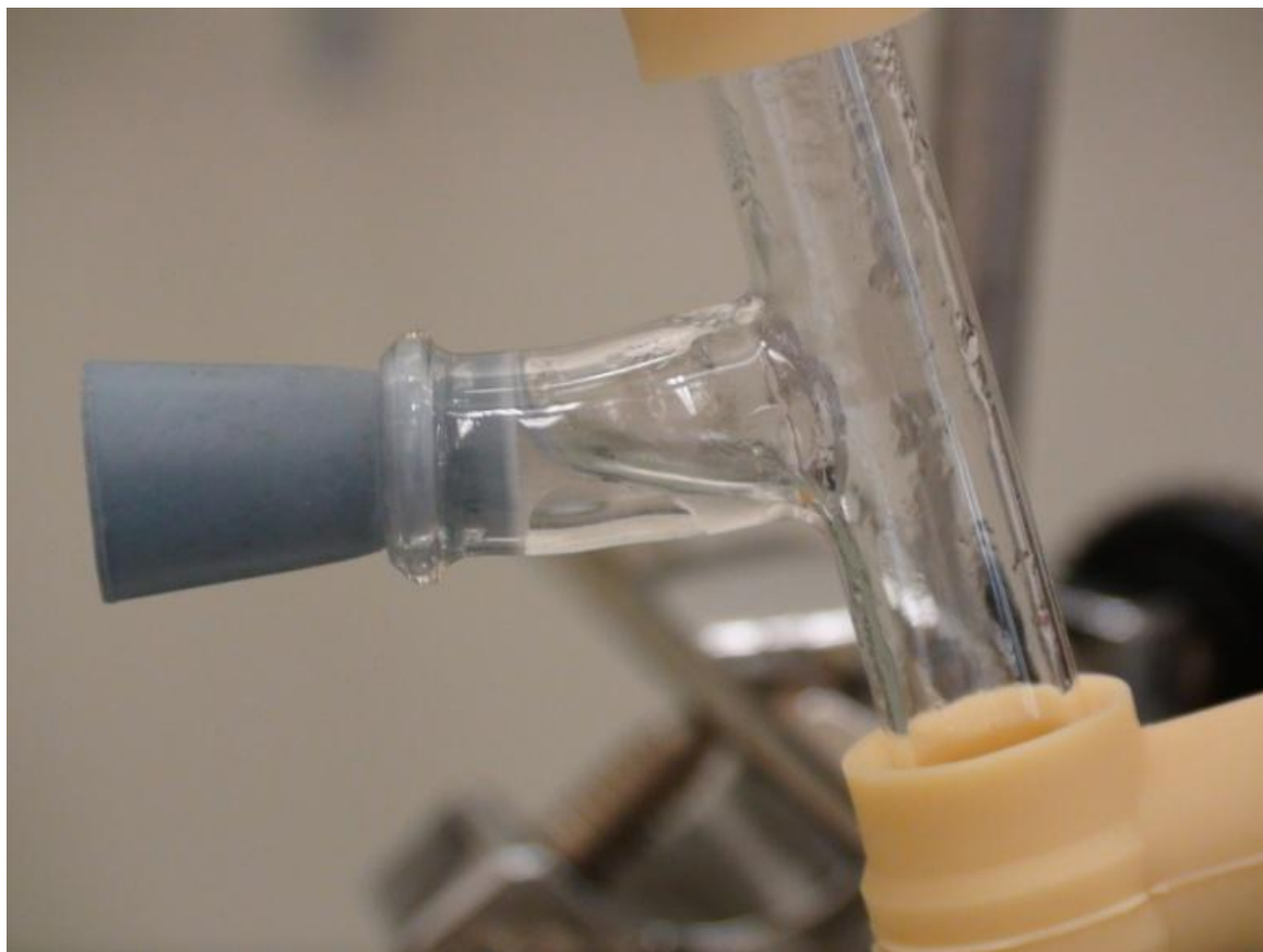
Figura 3. Introdução da fases orgânica na mistura reaccional
