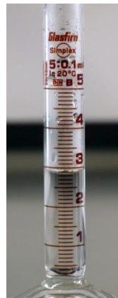
Figura 6. Proveta com o condensado.
