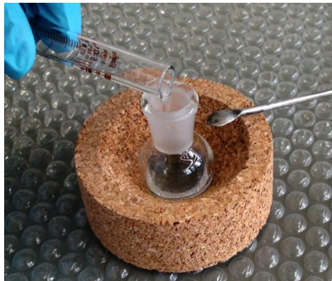
Figura 2. Transferir a solução para o balão de fundo redondo.
