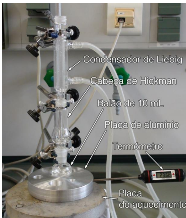
Figura 3. Montagem da destilação simples a microescala. Figura 4. Montagem com equipamento para medir energia.
