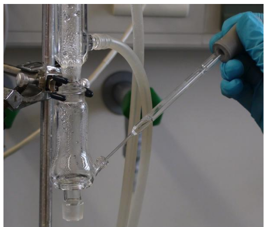
Figura 7. Retirar toda a água presente na cabeça de Hickman.
