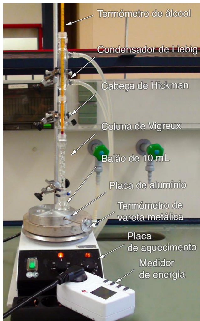
Figura 2. Montagem da destilação fracionada a microescala.
