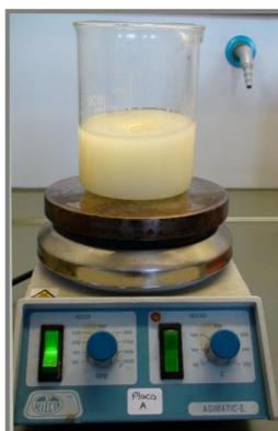
Figura 2 - Mistura reacional após adição da mistura de ácido acético/água
