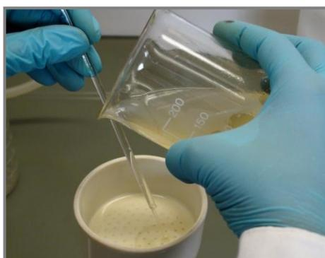
Figura 5 - Filtração da mistura por sucção
