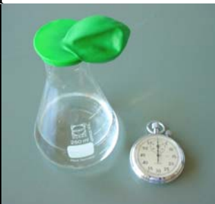
Figura 7 – Montagem; a pastilha de Alkaseltzer encontra-se inserida no interior do balão
