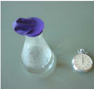
Figura 11 – Montagem; a pastilha de Alkaseltzer encontra-se inserida no interior do balão
