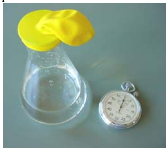
Figura 3 – Montagem; a pastilha de Alkaseltzer encontra-se inserida no interior do balão
