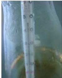
Figura 9 – Medição da temperatura do vinagre (cerca de 45°C).
