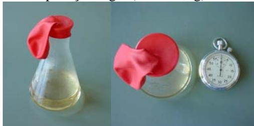
Figura 6 – Montagem; o pedaço de giz encontra-se inserido no interior do balão.
