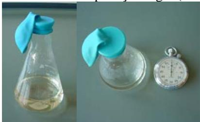
Figura 6 – Montagem; o pedaço de giz encontra-se inserido no interior do balão.
