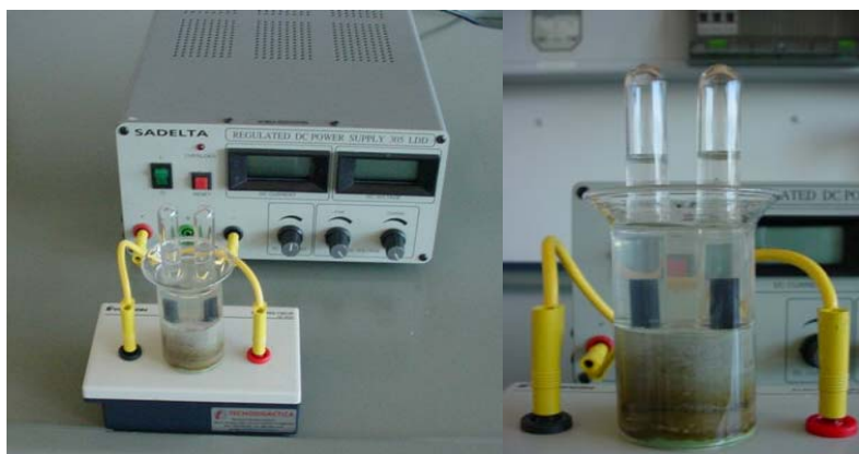
Montagem para proceder a electrólise da água.
