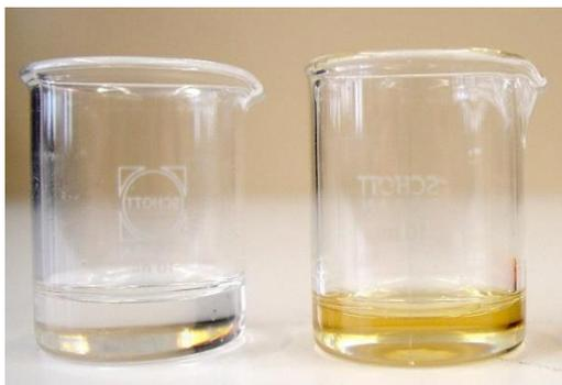
**Figura 5S.** Comparação entre o óleo obtido por destilação por arrastamento de vapor (esquerda) e um óleo de laranja comercial (direita)
