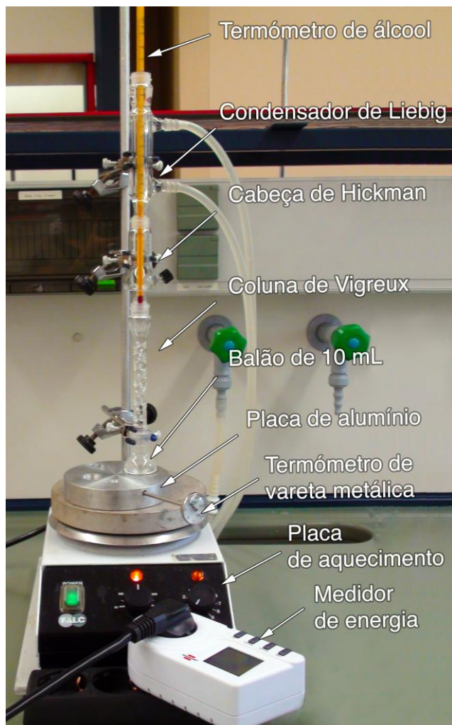
Figura 2. Montagem da destilação fracionada a microescala.
