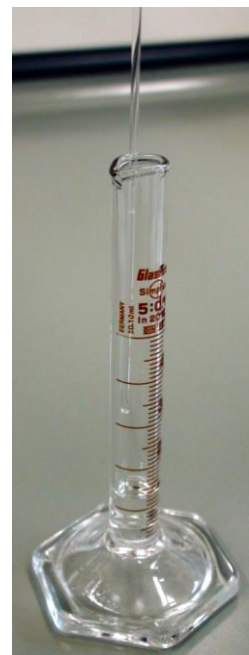
Figura 5. Proveta com o condensado.
