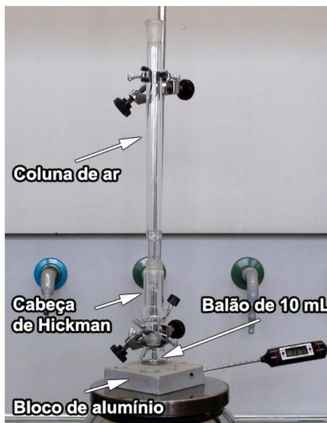
Figura 2. Montagem utilizando uma coluna de ar
