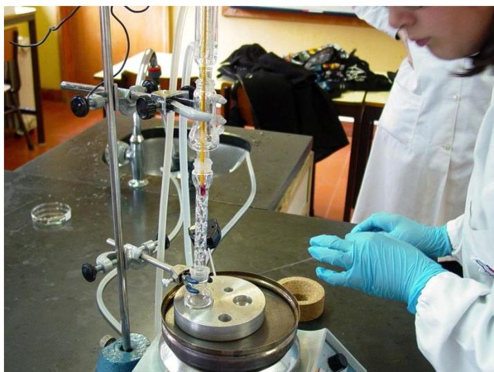
**Figura 2.** Destilação de uma solução de acetona (propanona) em água, Escola Secundária de Valongo.
