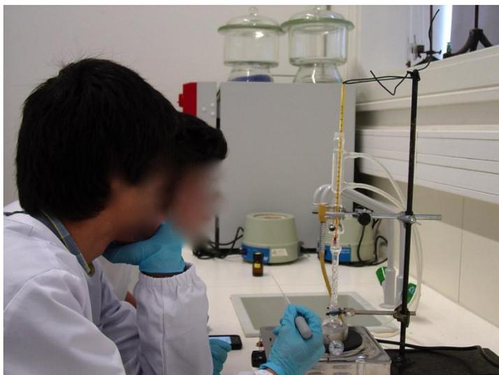
**Figura 3.** Destilação de uma solução de acetona (propanona) em água, Escola Básica e Secundária Rodrigues de Freitas
