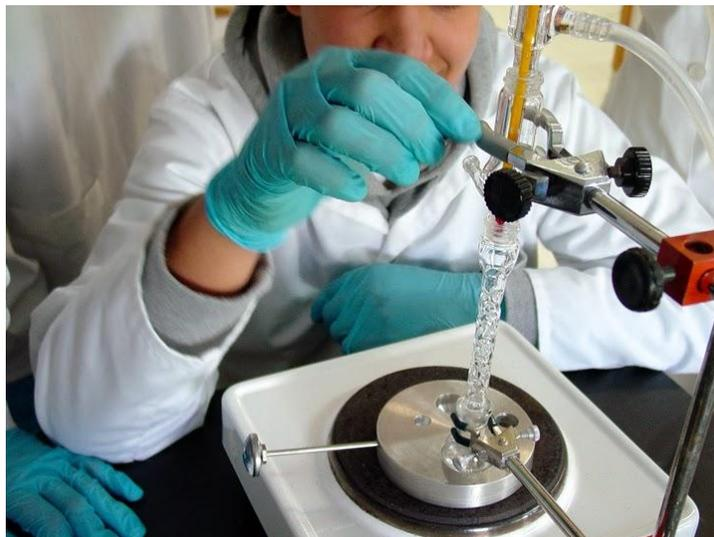
**Figura 1.** Destilação de uma solução de acetona (propanona) em água, Escola Secundária de Vilela
