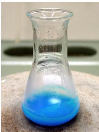
**Figura 6 – Precipitado de hidróxido de cobre(II) antes do aquecimento.**
