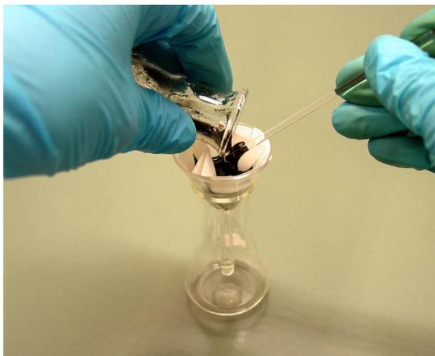
**Figura 9 – Filtração do óxido de cobre(II).**
