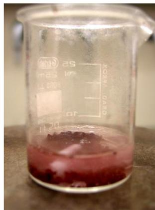
**Figura 14 – Formação do cobre sólido.**
