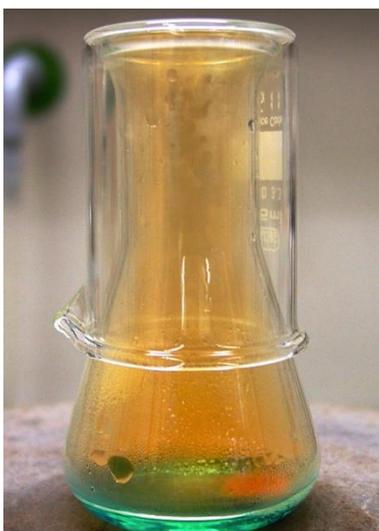
Figura 3 – Vapores de  $\text{NO}_2$  libertados durante a reação.
