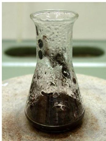
**Figura 7 – Formação do óxido de cobre(II) durante o aquecimento.**
