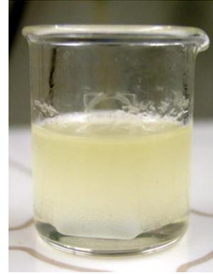
**Figura 7** – Formação de duas fases após adição de água desionizada.
