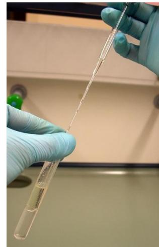
**Figura 9** – Transferência da fase superior que contém o biodiesel com uma pipeta Pasteur para um tubo de ensaio.
