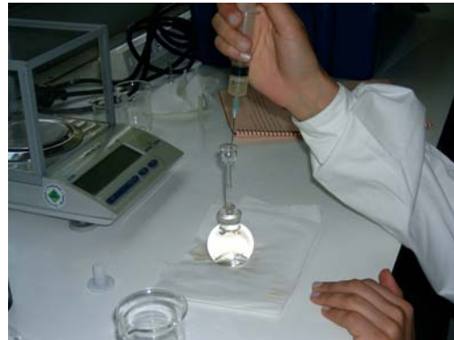
Figura 3: Acerto do menisco da solução com o colo do frasco.
